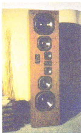
Bild 5 Paradeperd: Der neue Aktiv-High-End-Monitor «La Scala» arbeitet dank digitalen Filtern völlig phasentreu und besitzt dank «negativer Ausgangsimpedanz» der Endstufen ein umwerfendes Impulsverhalten.
