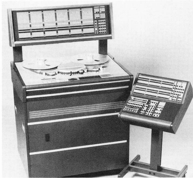
Bild 2 Die D820-48: Der grösste Brocken ist der Schrank unterhalb des Laufwerks. Er ist vollgestopft mit Elektronik.
