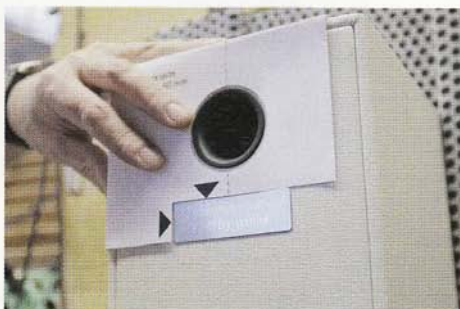
Bis ins Detail: Auch die Herstellerplakette will millimetgenau platziert werden.
