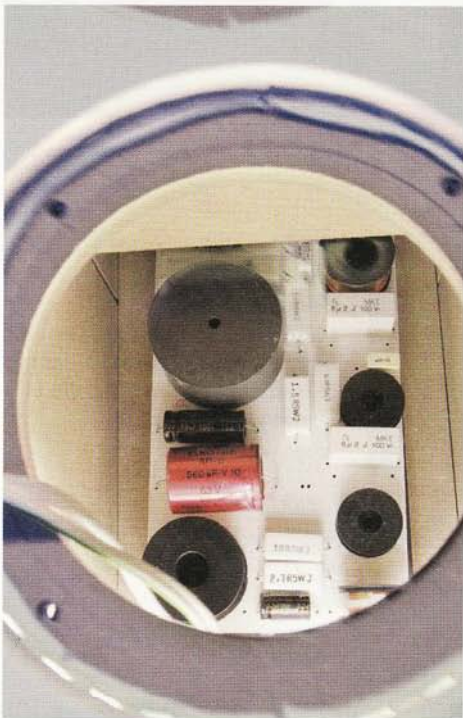
Tiefer Einblick: Die Weiche durch die Treiberöffnung gesehen.
