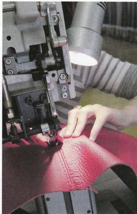
Saubere Naht: Die einzelnen Lederteile werden vernäht.
