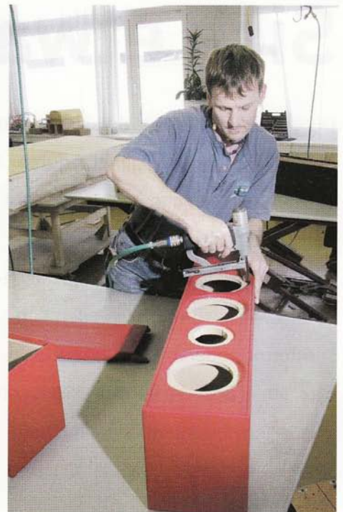
Gute Haut: Das Gehäuse erhält sein Lederkleid.
