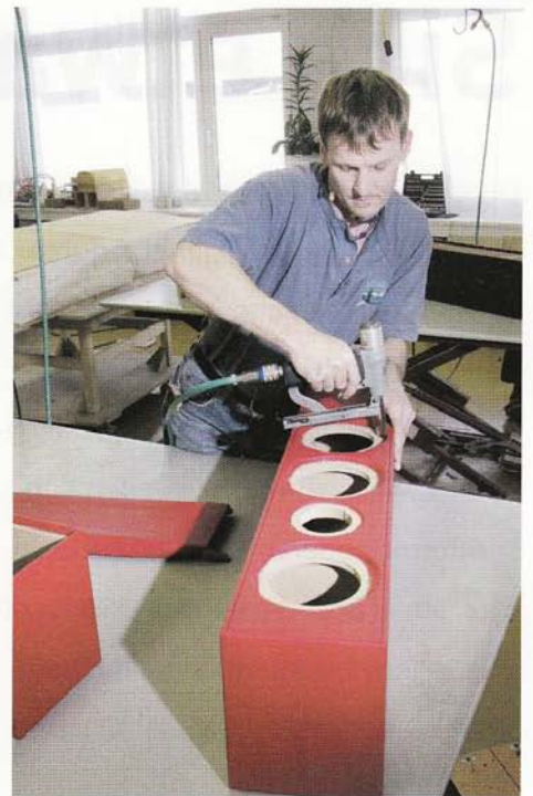
Gute Haut: Das Gehäuse erhält sein Lederkleid.
