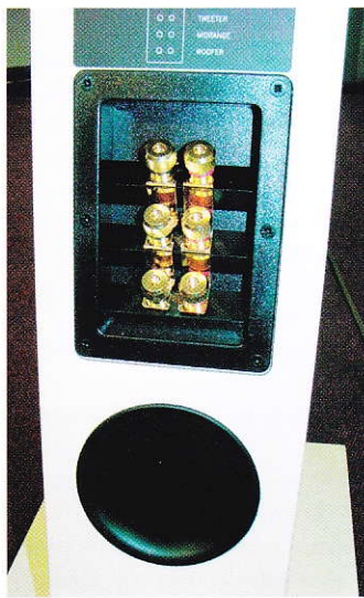
Triamping: Bei der Scala Brilliant lassen sich Tief-, Mittel- und Hochtonzweig separat mit dem bzw. den Verstärkern verbinden.
