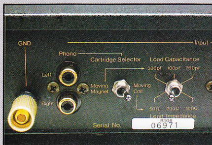
Komfort an der Rückfront auch bei Nakamichi: Je drei verschiedene Impedanzen für MM und MC
