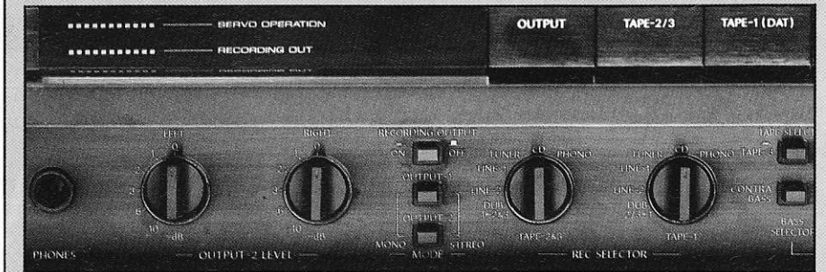
Versenkte Nebenfunktionen auch beim Onkyo-Vorverstärker: doppelte Simultanaufnahme, Pegelsteller für Ausgang 2 und separate Mono-Schalter für die beiden Hauptausgänge
