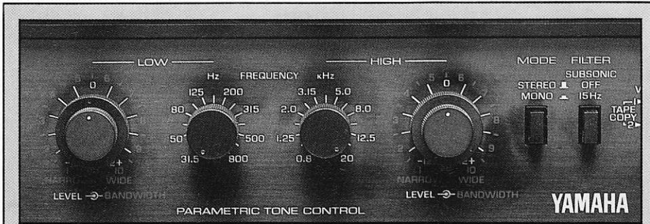
Komfort unter der Klappe: Parametrischer Equalizer des Yamaha C-85. Baß- und Höhensteller können in Frequenz und Bandbreite beliebig variiert werden
