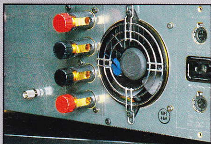
Da ist kein Kabel zu dick: Mächtige, vergoldete „Binding Posts“ an der Revox-Endstufe
