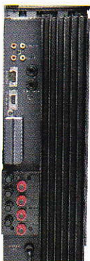
Die Anschlüsse für den Multiroom-Betrieb und das zweite Display stammen aus der PC-Welt
