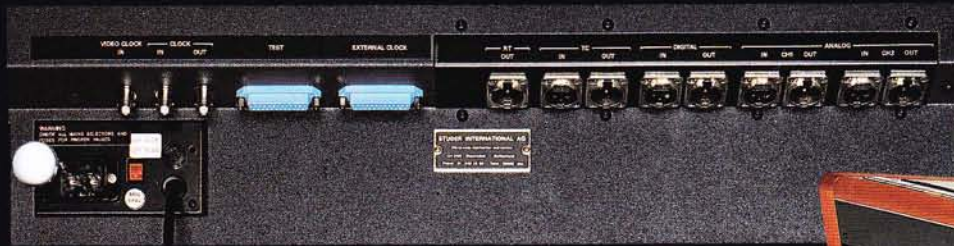
BNC-, D-Type- und XLR-Anschlüsse auf der Rückwand der PCM-Box.
