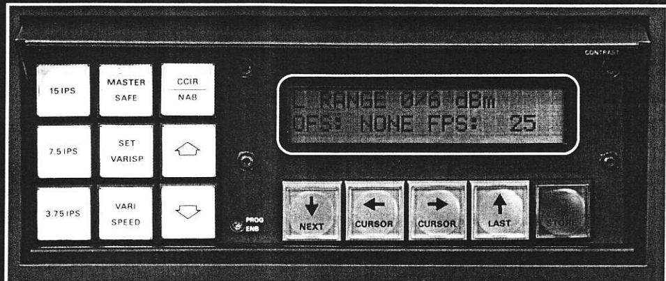
Programmier- und Anzeigezentrum für die prozessorgesteuerte Laufwerk- und Audio-Elektronik.
