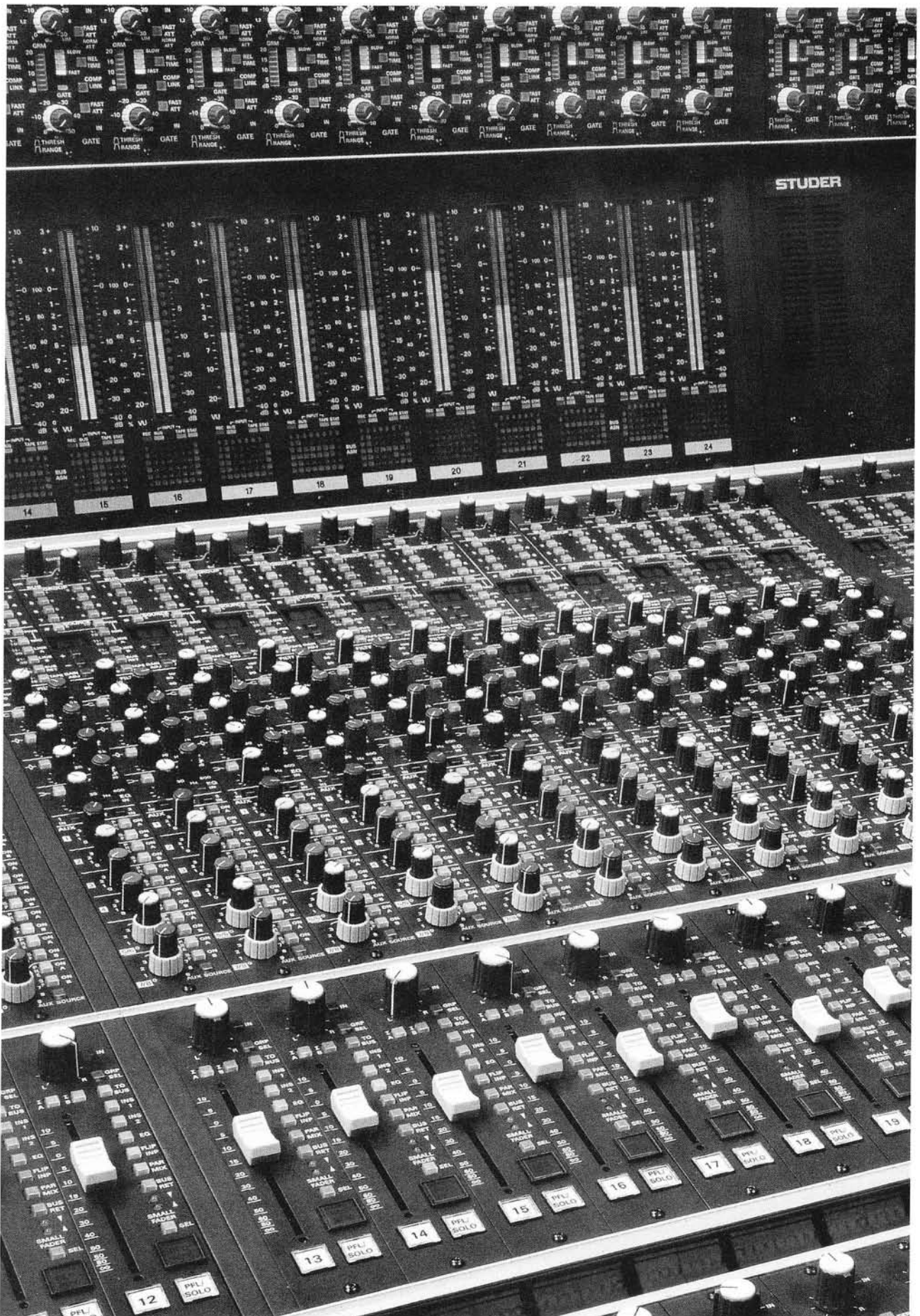
„Studer 990“ – Inline Produktionskonsole mit digitaler Steuerung.
