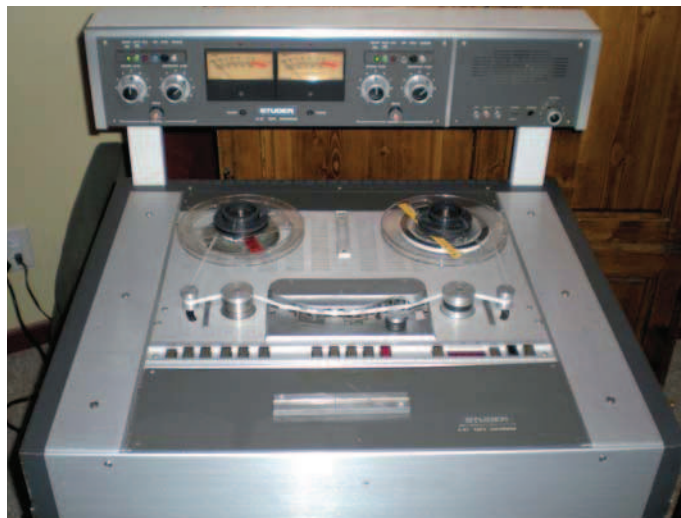
Nicht selten: B67 in der Studer-Truhe. Hochinteressant: Das VU-Panel in der Brücke lässt sich auch in das Gerät einbauen
