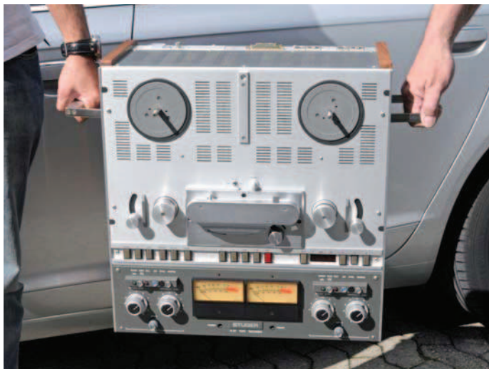
B67, die kompakte Studiomaschine von Studer: bequem zu transportieren an den ausklappbaren Tragegriffen
