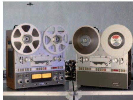
Zwei Aggregatzustände: wohnzimmertaugliche B67 mit VU-Metern (l.) gegenüber der rein zweckmäßigen Studioausführung
